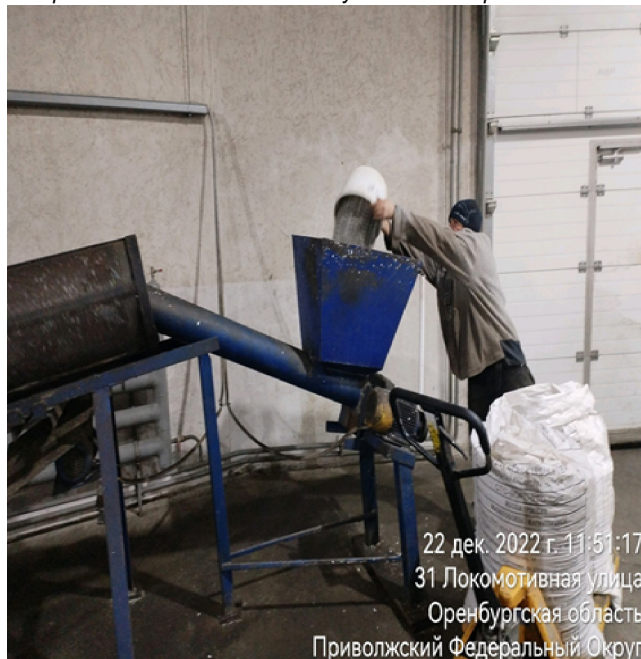
Изображение №6: Ситовая машина
