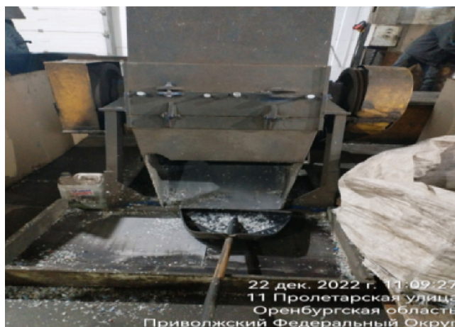
Изображение №5: Измельчение бутылки ПЭТ-флекса
